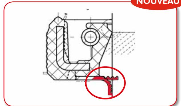
Image 1: Nouvelle bague d'étanchéité 20034245B avec lèvre antipoussière
