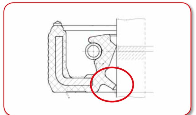
Image 2: Bague d'étanchéité 20034245B standard
